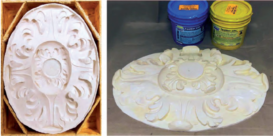
Fig. 22. Molde de silicona y vaciado en resina de poliuretano de baja densidad.
